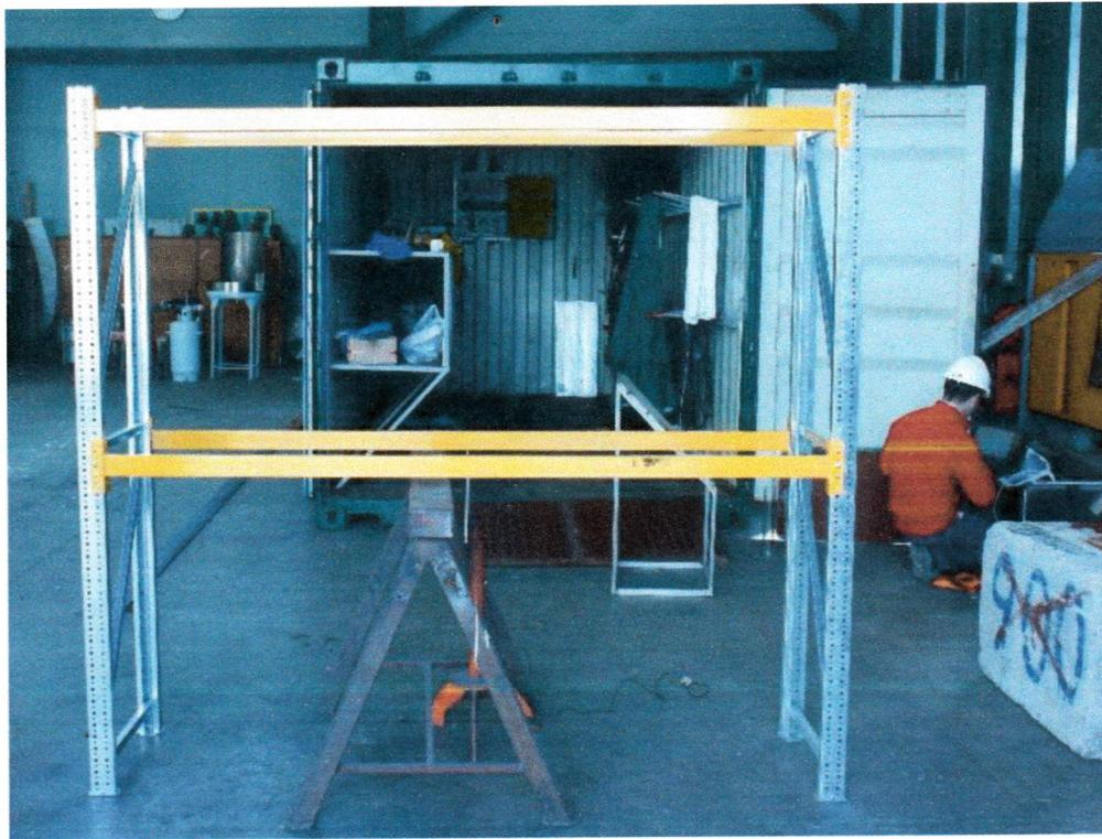
Εικόνα 4-1 Το σύστημα ραφιών όπως τοποθετήθηκε με τον κατακόρυφο αισθητήρα στην μέση της δοκού στο κάτω ράφι , πρίν την δοκιμή.
