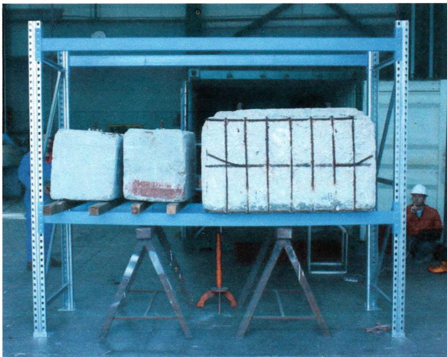
Εικόνα 4-7 Το κάτω ράφι του συστήματος σε πλήρη φόρτιση
