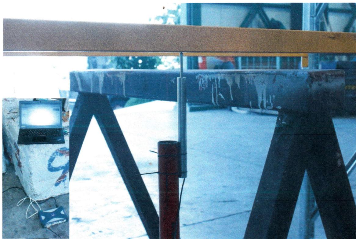
Εικόνα3-2.Ο κατακόρυφος αισθητήρας μέτρησης των μετατοπίσεων , μαζί με το υπολογιστικό σύστημα υποδοχής δεδομένων (άκρη αριστερά )
