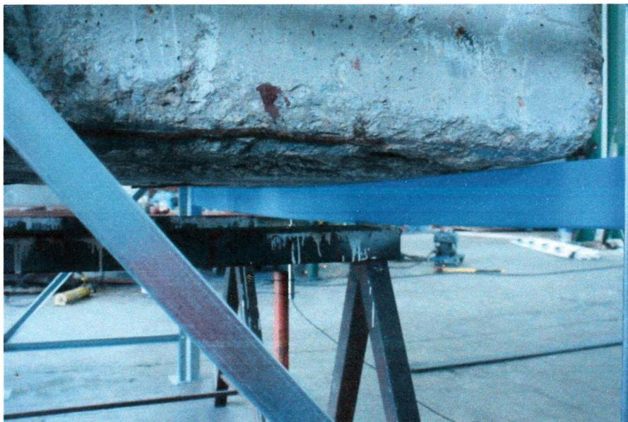
Εικόνα 4-9 Το κάτω ράφι του συστήματος σε μέγιστη παραμόρφωση.
